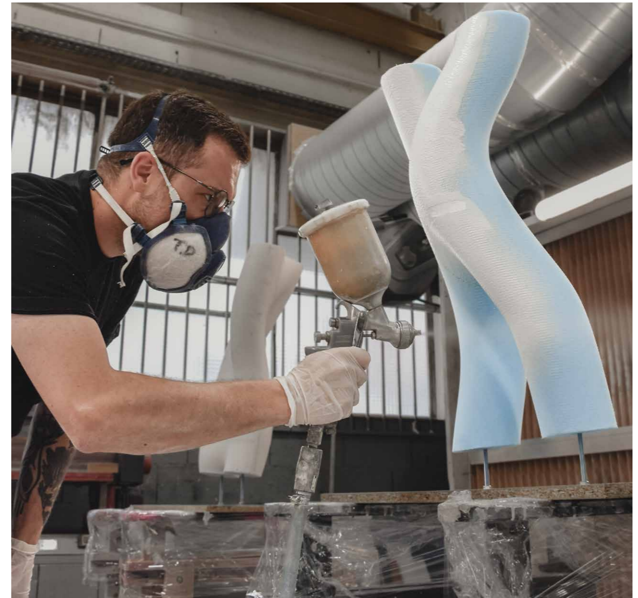
▲ Projection de note solution Minero®, composite minéral composé d'un mortier utilisant des matières minérales recyclées.
